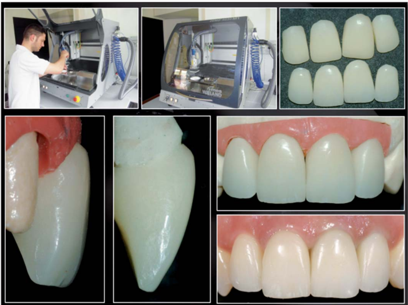
Fig. 15 Esecuzione CAM di un doppio set di provvisori in PMMA con differenti profili di emergenza
